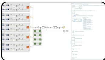
PV\*SOL® premium respalda el diseño de su sistema con un **diagrama de circuito libremente configurable**. Se pueden determinar tanto las pérdidas de los conductores de cadena, como las pérdidas de los cables de C.A. y C.C. por inversor. Se pueden añadir diversos símbolos de circuito, como las protecciones eléctricas.
